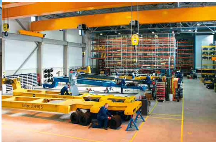
Blick in die Produktionshalle, wo u. a. die Schwerlasthubwagen vom Typ LTH 90 montiert werden
