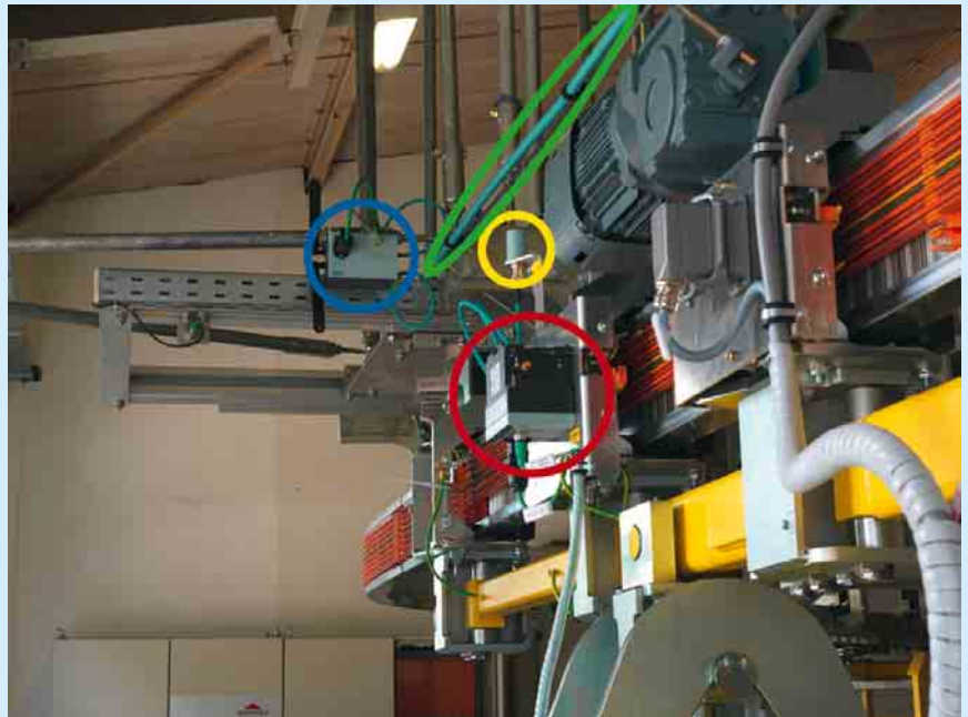
③ „Industrial Wireless LAN“-Performance mit Rapid Roaming: Dual Access Point Scalance W788-2 RR (blau markiert), Client Modul Scalance W747-1 RR (rot), RCoax-Leckwellenleiter (grün) und omnidirektionale Antenne ANT793-4MN (gelb) für schnellen, berührungslosen Datenaustausch zwischen Fahrwagen, zentraler Steuerung und Lagerverwaltungsrechner
